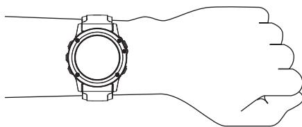
**OBSERVAÇÃO:** o sensor óptico encontra-se na parte de trás do dispositivo.
