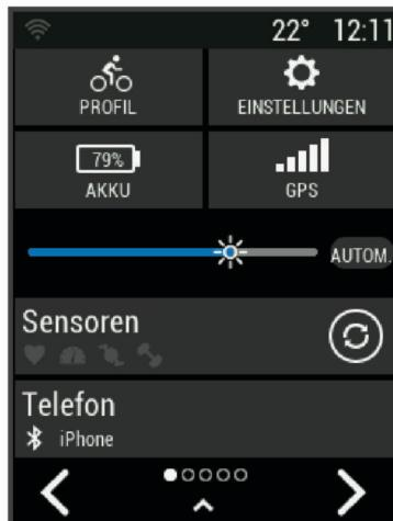
Das Einstellungs-Widget wird angezeigt. Wenn ein Icon blinkt, sucht das Gerät ein Signal. Wenn das Icon leuchtet, wurde das Signal gefunden oder der Sensor ist verbunden. Sie können ein beliebiges Symbol auswählen, um die Einstellungen zu ändern.
