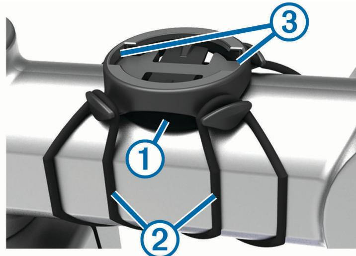
3 Setzen Sie die Fahrradhalterung auf den Lenkervorbaus auf.
