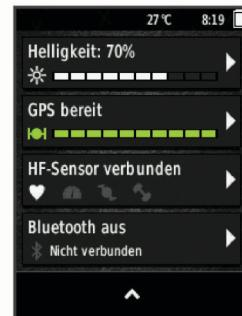
Die Statusseite von Sensoren und Verbindungen wird angezeigt. Wenn ein Symbol blinkt, führt das Gerät eine Suche durch.
