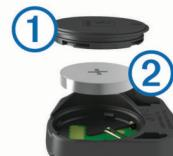
2 Drehen Sie die Abdeckung entgegen dem Uhrzeigersinn, bis die Markierung auf die entsperrte Position zeigt und sich die Abdeckung abnehmen lässt.
