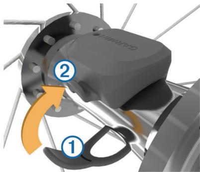
O sensor pode ficar inclinado se for instalado num cubo assimétrico. Isto não afeta o funcionamento.
