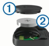
2 Rode a tampa para a esquerda até o marcador indicar que está na posição desbloqueada e a tampa estiver solta o suficiente para a remover.
