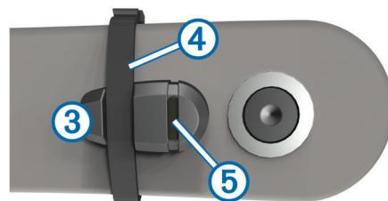
O íman do pedal deve encontrar-se a 5 mm do GSC 10. A linha de indicação ⑤ no íman do pedal deve estar alinhada com a linha de indicação ⑥ no GSC 10.
