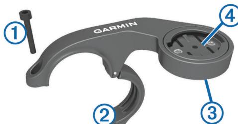
3 Entferne bei Bedarf die zwei Schrauben an der Rückseite der Halterung ③, drehe das Verbindungsstück ④, und setze die Schrauben wieder ein, um die Ausrichtung der Halterung zu ändern.
