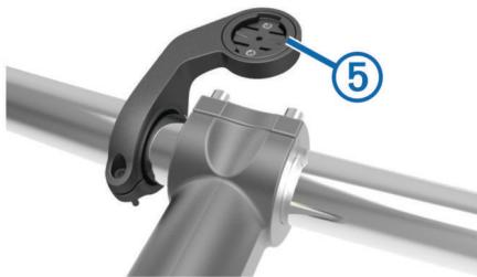
8 Drücke den Edge leicht nach unten, und drehe ihn im Uhrzeigersinn, bis das Gerät einrastet.
