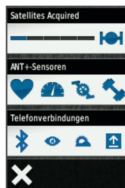
Die Statusseite der Sensoren und Verbindungen wird angezeigt. Wenn ein Symbol blinkt, führt das Gerät eine
