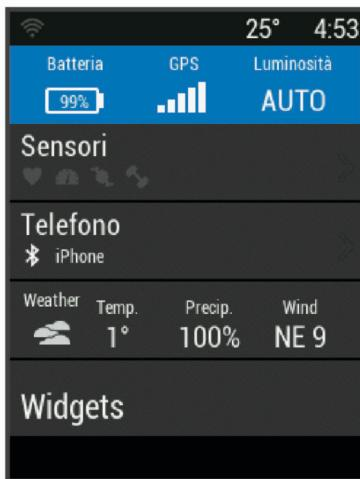
Viene visualizzata la pagina di stato. Un'icona lampeggiante indica che il dispositivo sta cercando un segnale. Un'icona fissa indica che il segnale è stato trovato o che il sensore è connesso.
