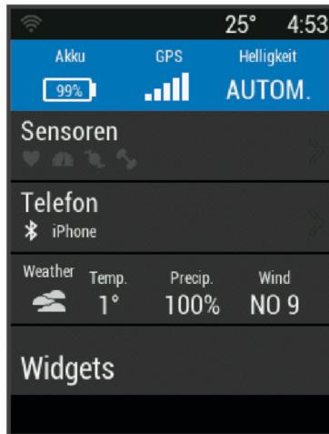
Die Statusseite wird angezeigt. Wenn ein Icon blinkt, sucht das Gerät ein Signal. Wenn das Icon leuchtet, wurde das Signal gefunden oder der Sensor ist verbunden.
