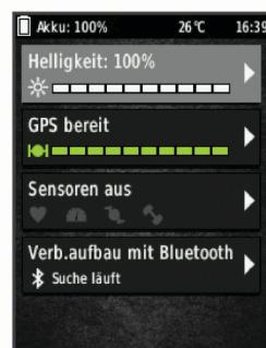
Die Statusseite wird angezeigt. Wenn das Icon leuchtet, wurde das Signal gefunden oder der Sensor ist verbunden.
