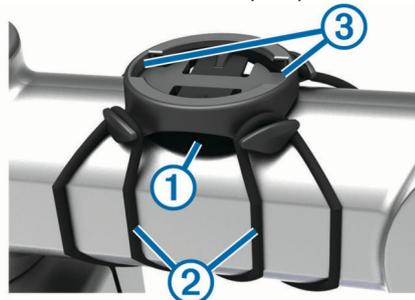
3 Coloca el soporte para bicicleta en la potencia de la bicicleta.
