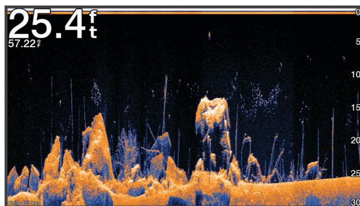
传统换能器会发出锥形波束。Garmin ClearVü 扫描声纳技术会发出与复印机中光束形状相似的波束。此波束可提供船只底下物体的更清晰的图片式图像。
