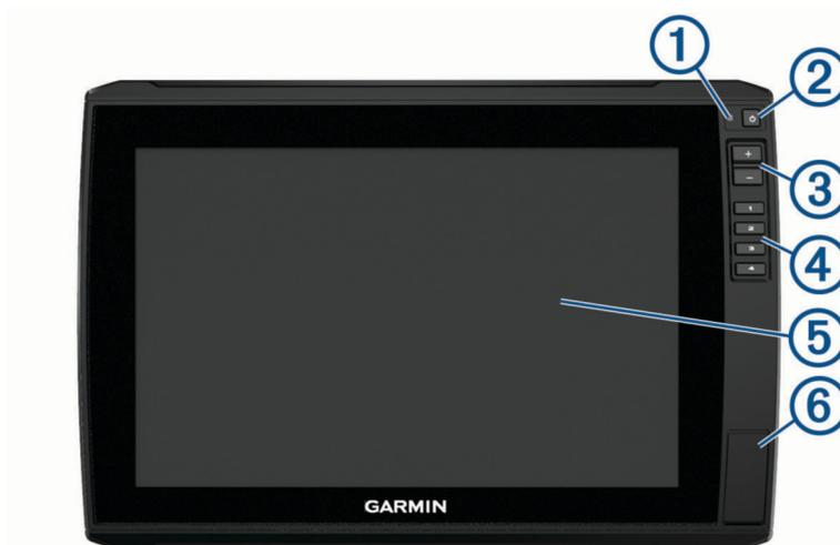
① Sensor de retroiluminação automática
