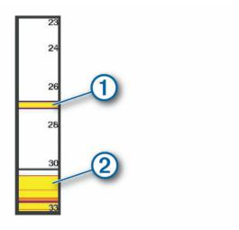
El A-Scope que se muestra arriba muestra lecturas de peces ① y retorno del fondo blando ②. En una vista de sonda, selecciona **MENU** > **Configuración de sonda** > **Presentación** > **A-Scope**.
