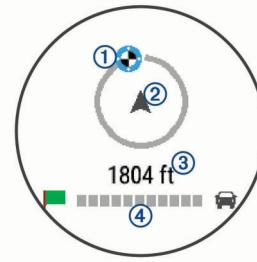
目的地指示符①显示相对于您前进方向②的目的地方向。如果目的地指示符出现在圆圈上方，则表示您正在走向目的地。离目的地的剩余距离③显示在圆圈下方。进度条④显示您前往目的地的进度。
