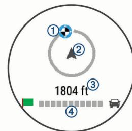
目的地インジケータ①は、移動している方向②に対する目的地の相対的な方向を示しています。目的地インジケータが円の上部に表示されたら、目的地に向かっています。目的地までの残りの距離③が円の下に表示されます。進行状況バー④により目的地までの進行状況を示します。
