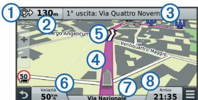
Le indicazioni relative alla svolta o all'uscita successiva o altre azioni vengono visualizzate nella parte superiore della mappa. Il simbolo ① indica il tipo di azione e la corsia o le corsie da percorrere, se disponibili. Il dispositivo visualizza anche la distanza dall'azione successiva ② e il nome della via o dell'uscita associata a tale azione ③.
