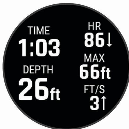
**Schermata in immersione:** visualizza le informazioni sull'immersione corrente, incluso il tempo trascorso, la profondità massima e corrente, i dati sulla frequenza cardiaca e la velocità di salita o di discesa.
