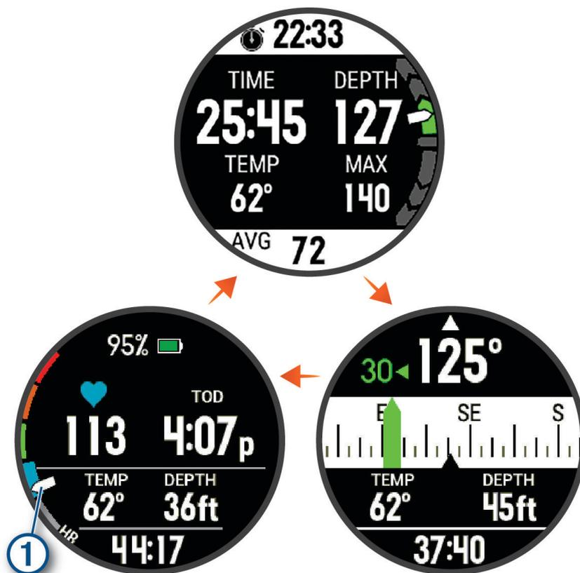
**Cronometro per immersioni:** visualizza il cronometro del tempo sul fondale, la profondità corrente, la massima e la media; e la velocità di salita o di discesa (*Uso del cronometro, pagina 14*).
