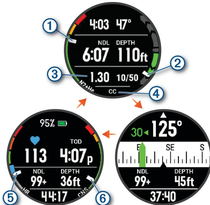
**Schermata dei dati principali:** visualizza i dati di immersione principali, incluso il gas e la velocità di risalita o discesa.
