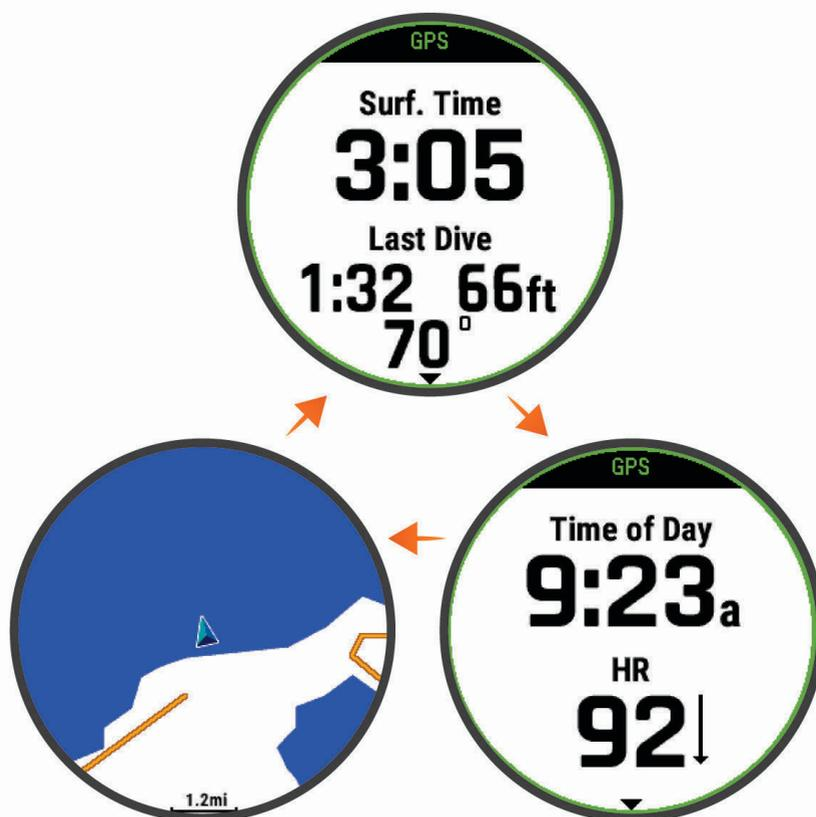
**Schermata intervallo in superficie:** visualizza il tempo di intervallo in superficie corrente, nonché il tempo trascorso, la profondità massima e la temperatura per l'ultima immersione in apnea.
