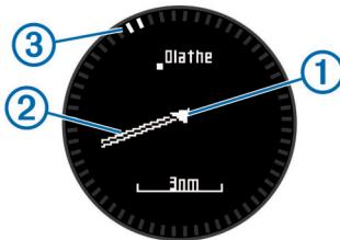
Auf der Karte werden die aktuelle Position ①, der zu verfolgende Track ② und der Endpunkt ③ angezeigt.
