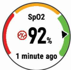
**NOTA:** se si è troppo attivi affinché il dispositivo determini la saturazione di ossigeno, vengono mostrati dei trattini anziché una percentuale. È necessario restare immobili per 30 secondi affinché il dispositivo legga la saturazione di ossigeno nel sangue.
