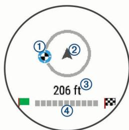
El indicador del destino **①** muestra en qué dirección se encuentra tu destino en relación a la dirección en la que estás avanzando **②**. Cuando el indicador del destino se muestra en la parte superior del círculo, significa que tu dirección es correcta. La distancia restante hasta tu destino
