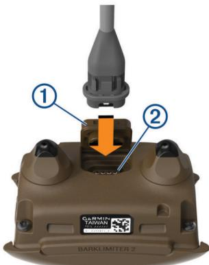
2 Conecta el cable de alimentación a una fuente de alimentación.
