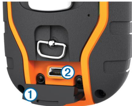
**2** Stecken Sie das schmale Ende des USB-Kabels in den Mini-USB-Anschluss **②** am Gerät.
