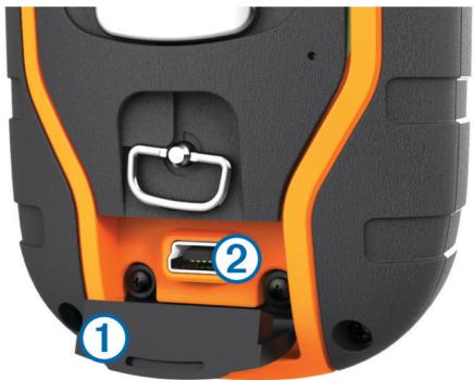
**2** Schließen Sie den kleinen Stecker des Netzkabels an den Mini-USB-Anschluss **②** am Gerät an.
