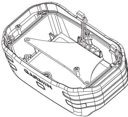
**12** Vérifiez que le joint n'est pas endommagé et qu'il est entièrement enfoncé dans la rainure.
