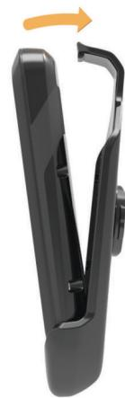
**3** Para remover o dispositivo, levante a parte superior do clipe enquanto pressiona a parte posterior do dispositivo e deslize a parte inferior do dispositivo para fora, pela parte inferior do clipe.
