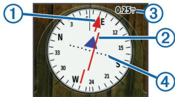
El puntero de trayecto ① indica tu relación respecto a la línea de trayecto que conduce al destino. El indicador de desvío de trayecto (CDI) ② proporciona la indicación de desvío (derecha o izquierda) del trayecto. La escala ③ corresponde a la distancia existente entre los puntos ④ del indicador de desvío de trayecto, que te indica la distancia que te has desviado respecto al trayecto.
