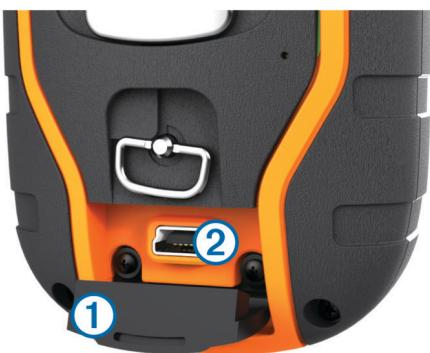
2 Branchez la petite extrémité du câble d'alimentation sur le port mini-USB ② situé sur l'appareil.
