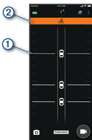
O ① de posicionamento do veículo se move para cima da tela conforme o veículo se aproxima da bicicleta. O banner de nível de ameaça ② muda de cor com base no nível potencial da ameaça. Verde indica que nenhum veículo foi detectado. Âmbar indica que um veículo está se aproximando. Vermelho indica que um veículo está avançando a uma velocidade elevada.
