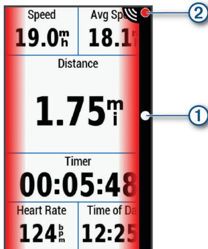
O LED de posicionamento do veículo ① se move para cima conforme o veículo se aproxima da bicicleta. O LED de nível de ameaça ② muda de cor com base no nível potencial da ameaça. Verde indica que nenhum veículo foi detectado. Âmbar indica que um veículo está se aproximando. Vermelho indica que um veículo está avançando a uma velocidade elevada.
