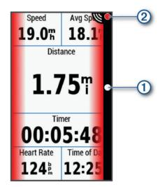
Il LED di posizione del veicolo ① si illumina mano a mano che un veicolo si avvicina alla bici. Il LED del livello di pericolo ② cambia colore in base al potenziale livello di pericolo. Il verde indica nessun veicolo è rilevato. Ambra indica un veicolo in avvicinamento. Rosso indica che un veicolo sta avanzando ad alta velocità.
