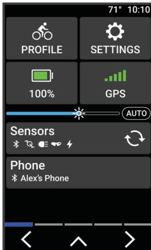
Aparece el widget de estado. Si el icono parpadea, significa que el dispositivo está buscando. Si el icono permanece fijo, significa que se ha encontrado señal o que el sensor está conectado.
