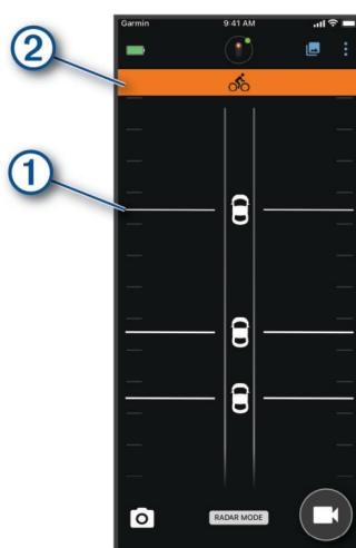
La posición del vehículo ① se desplaza hacia arriba por la pantalla conforme el vehículo se va acercando a la bicicleta. La sección del nivel de amenaza ② cambia de color según el nivel potencial de amenaza. El color verde indica que no se ha detectado ningún vehículo. El color ámbar indica que se acerca un vehículo. El color rojo indica que un vehículo avanza a una velocidad alta.
