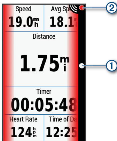
El LED de posición de vehículos ① sube por la columna según el vehículo se va acercando a tu bicicleta. El LED de nivel de amenaza ② cambia de color según el nivel potencial de amenaza. El color verde indica que no se ha detectado ningún vehículo. El color ámbar indica que se acerca un vehículo. El color rojo indica que un vehículo avanza a una velocidad alta.
