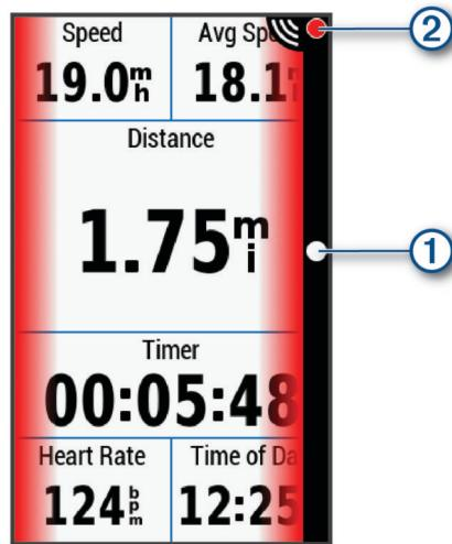
Il LED di posizione del veicolo ① si illumina mano a mano che un veicolo si avvicina alla bici. Il LED del livello di pericolo ② cambia colore in base al potenziale livello di pericolo. Il verde indica nessun veicolo è rilevato. Ambra indica un veicolo in avvicinamento. Rosso indica che un veicolo sta avanzando ad alta velocità.
