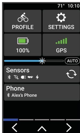
Viene visualizzato il widget delle impostazioni. Un'icona lampeggiante indica che il dispositivo sta cercando un segnale. Un'icona fissa indica che il segnale è stato trovato o che il sensore è connesso. Per modificare le impostazioni, selezionare un'icona.
