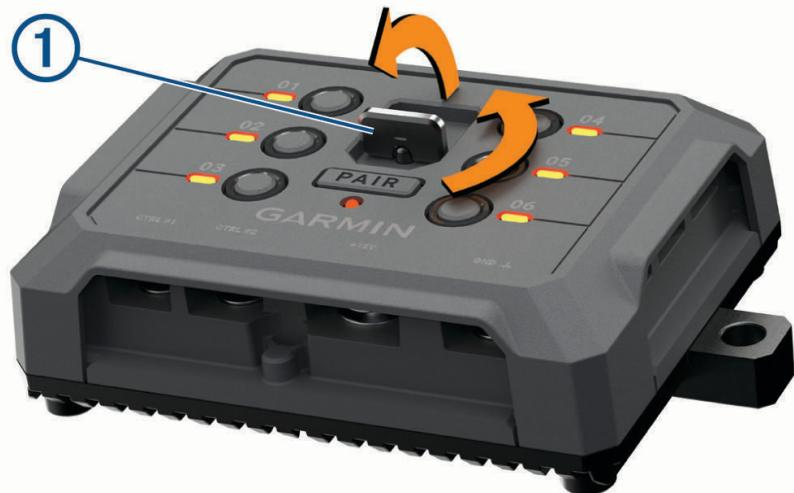
2 Снимите переднюю крышку с устройства.
