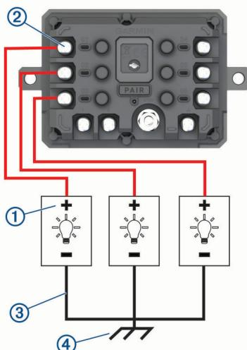
**2** Conecta el cable negativo o de conexión a tierra **③** a un pasador de conexión a tierra sin pintar **④** en el bastidor del vehículo, a un bloque de distribución a tierra o directamente al terminal negativo de la batería.
