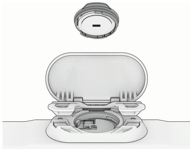
**5** Com cuidado, levante a bateria para fora da tampa no ponto de alavanca.
