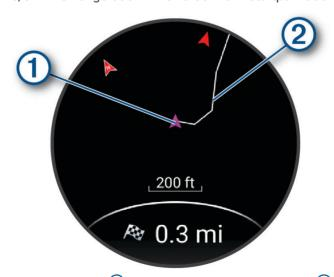
Auf der Karte werden die aktuelle Position (1) sowie der zu verfolgende Track (2) angezeigt.
