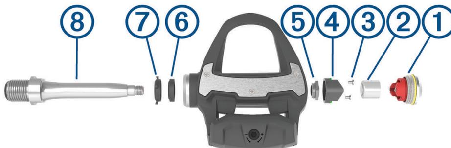
4 Utilize uma chave de fenda Phillips pequena (PH 00) para remover os dois parafusos ③ de dentro do carrinho da bateria ④.
