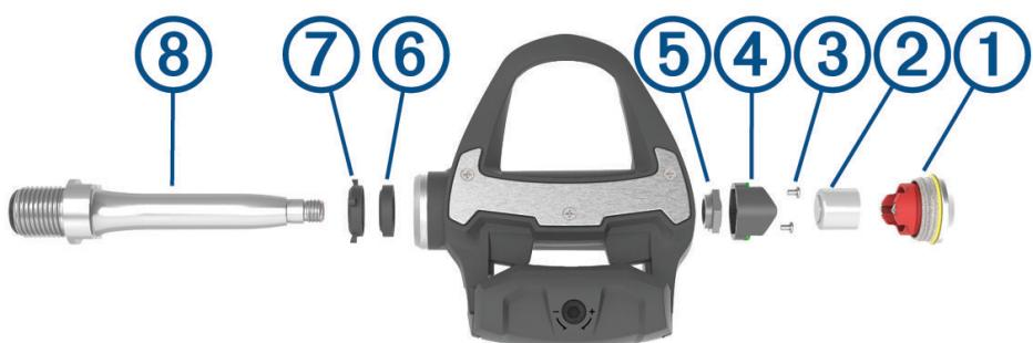
4 Utilizzare un piccolo cacciavite Phillips (PH 00) per rimuovere le due viti ③ all'interno del bullone della batteria ④.
