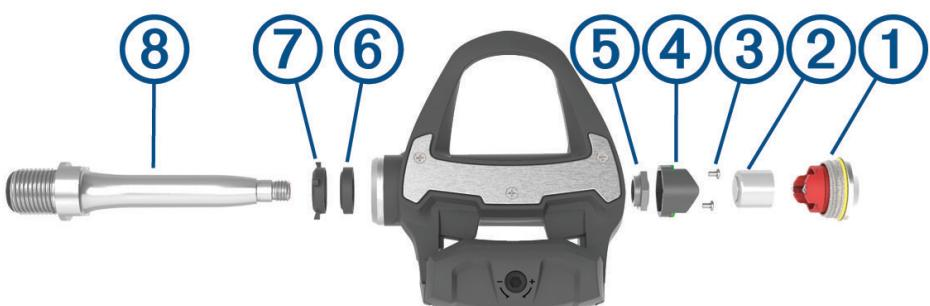
4 Utiliza un destornillador Phillips pequeño (PH 00) para retirar los dos tornillos ③ del interior del soporte de las pilas ④.
