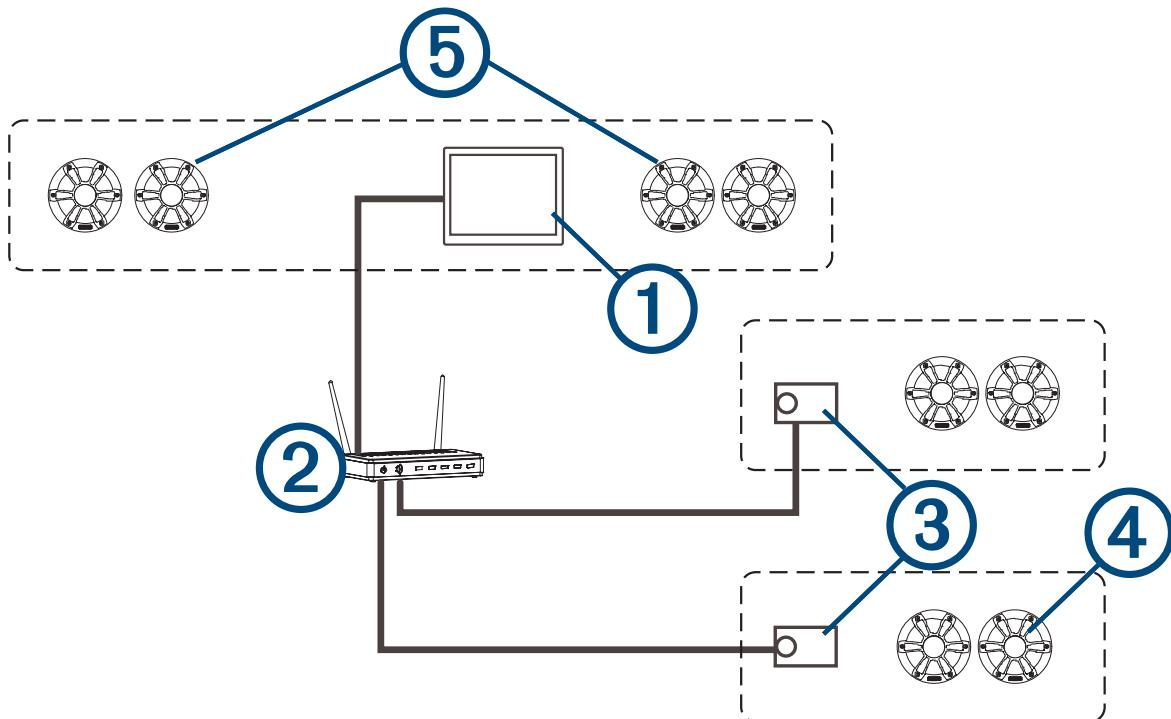
在上图中，1 个 Vieu RV 850 立体声音响 ① 连接至 1 个无线路由器 ② 和 2 个 Apollo SRX400 分区立体声音响 ③。两个 Fusion PartyBus 分区立体声音响可以流式传输 Fusion PartyBus 立体声音响的信号源。
