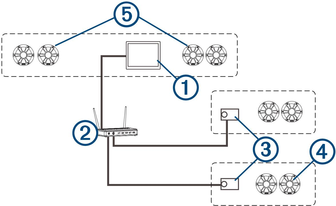
In der oben dargestellten Abbildung ist ein Vieu RV 850 Radio (1) mit einem WLAN-Router (2) und zwei Apollo SRX400 Zonenradios (3) verbunden. Die zwei Fusion PartyBus Stereo-Zonenradios können Quellen vom Fusion PartyBus Radio streamen.
