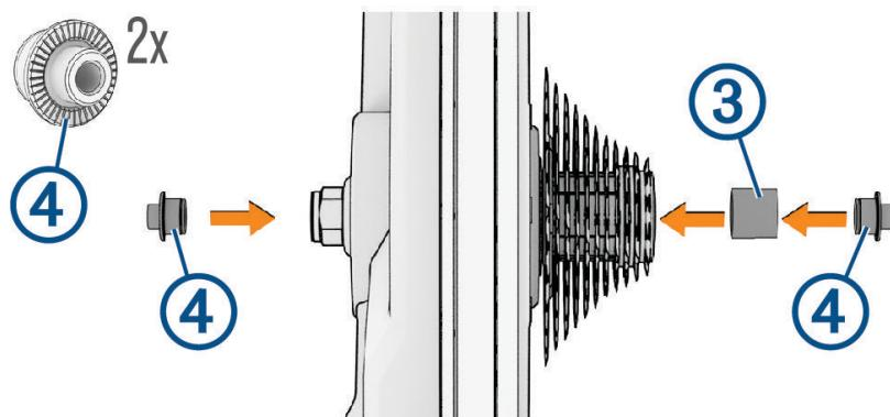
Anda dapat mengencangkan mur pengunci dengan tangan menggunakan alat berwarna biru. Saat menggunakan kunci torsi, Garmin® merekomendasikan torsi maksimum 6 N·m (4,4 lbf·ft.) untuk mur pengunci.
