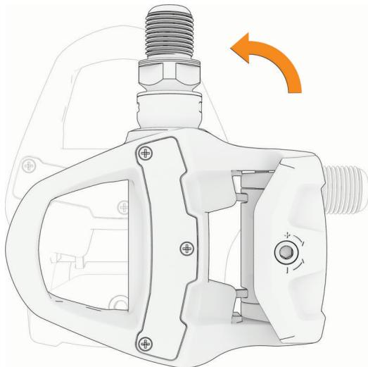
**5** Gire o pedal 90 graus e segure-o com a extremidade rosqueada para o lado por 2 segundos.
