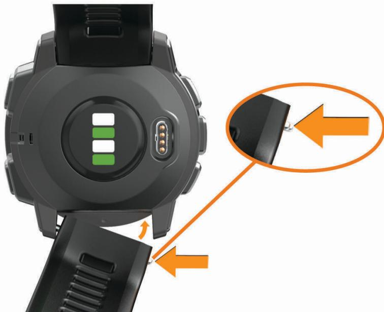
**HINWEIS:** Vergewissern Sie sich, dass das Armband sicher befestigt ist. Der Stift der Uhr muss auf die Löcher am Gerät ausgerichtet sein.
