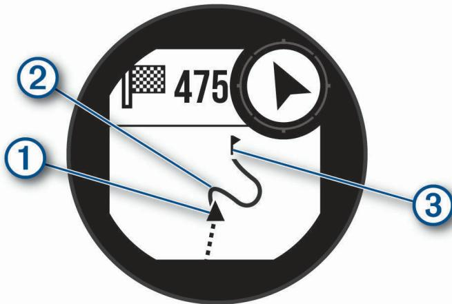
Auf der Karte werden die aktuelle Position (1), der zu verfolgende Track (2) sowie das Ziel (3) angezeigt.
