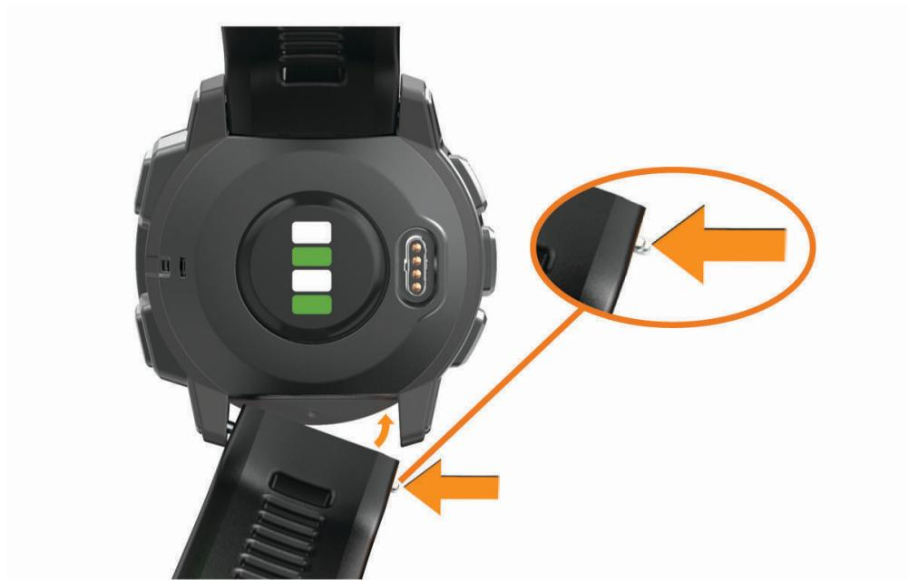
**NOTA:** asegúrate de que la correa está fija. El perno debe quedar alineado con los orificios del dispositivo.
