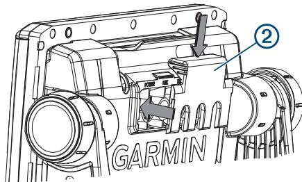
Wenn der Sicherungsbügel ordnungsgemäß einrastet, hören Sie ein Klickgeräusch.
