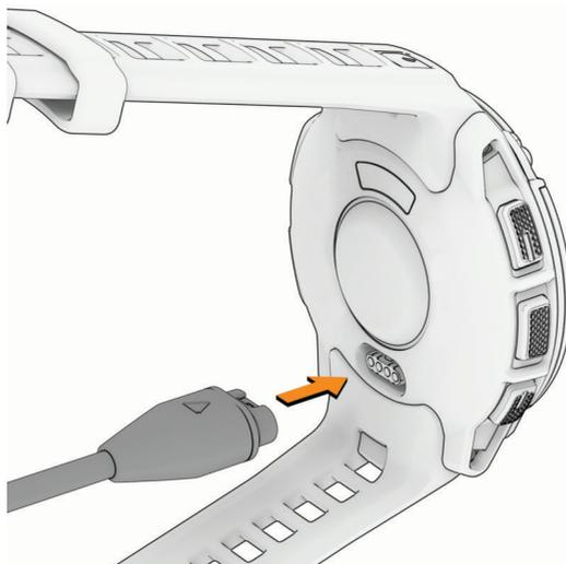
2 Collegare l'altra estremità del cavo a una porta USB-C® del computer o a un adattatore CA (potenza nominale minima di 5 W).
