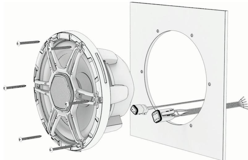
**18** Fissare l'altoparlante alla superficie di installazione utilizzando le viti in dotazione.
