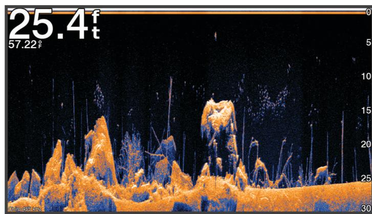
В обычных датчиках используются конусообразные лучи. Сонар Garmin ClearVü с технологией сканирования имеет луч, схожий по форме с лучом копировального аппарата. Этот луч обеспечивает более четкое, напоминающее фотографию изображение того, что находится под судном.
