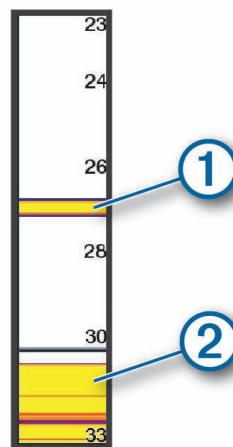
Im oben abgebildeten A-Bereich sind Fischsignale **①** und Signale für einen weichen Boden **②** zu sehen.
