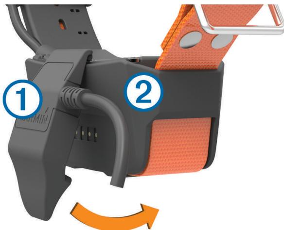
2 Подключите меньший разъем кабеля питания к порту mini-USB на кабеле зарядного зажима.
