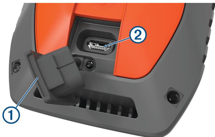
2 Подключите меньший разъем кабеля питания к порту USB ② на устройстве.
