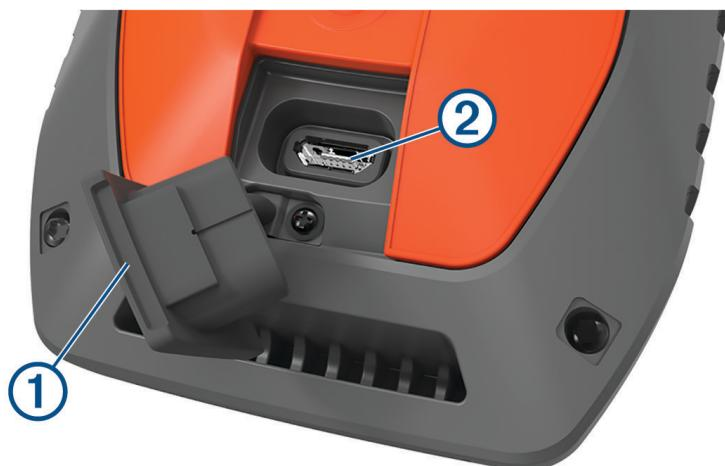
2 Introduza a extremidade pequena do cabo de alimentação na porta USB ② do dispositivo.
