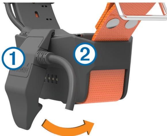
2 Conecta el extremo pequeño del cable de alimentación al puerto mini-USB del cable del clip cargador.
